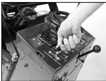
(D) Place Transmission Speed Lever in Neutral.
